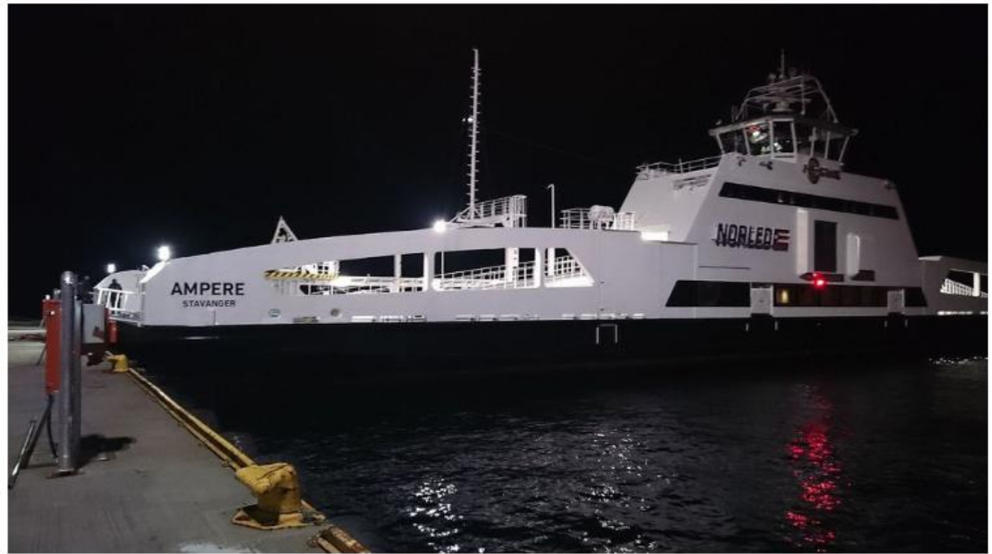
MF «Ampere» er verdens første el-ferge. Uten utviklingskontrakt fra Statens vegvesen, ville ikke fergen blitt bygget. Nå er batteriferges blitt mer eller mindre et krav der det er mulig. (Bilde: Vidarlo/Wikimedia Commons)
